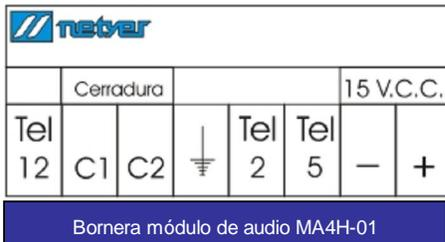
El MA4H-01 requiere 12Volts C.C. no regulada o 15 volts c.c. regulada para funcionar y un transformador adicional para la cerradura (o iluminación de las botoneras) de 12V c.a. 500 Ma. mínimo, no importa la cantidad de teléfonos ni las distancias entre teléfono interno y frente de calle.
