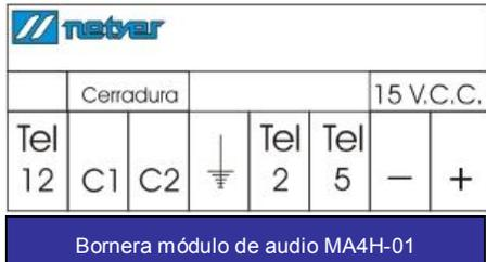
El MA4H-01 requiere mínimo 15Volts C.C. o 18 volts c.c. regulada para funcionar y un transformador adicional para la cerradura (o iluminación de las botoneras) de 15V c.a. 500 Ma. mínimo, no importa la cantidad de teléfonos ni las distancias entre teléfono interno y frente de calle.
